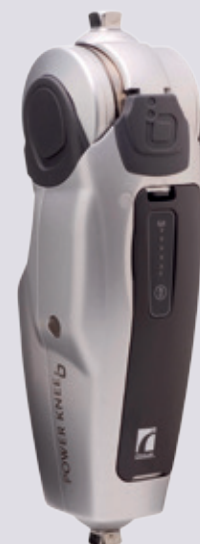
Power Knee : Assistance de la marche par microprocesseur. Permet la montée d'escalier à pas alternés.
